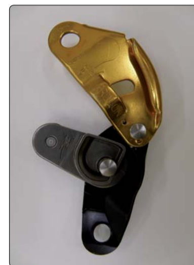
GRILLON Vačka bez pružiny se volně pohybuje.
